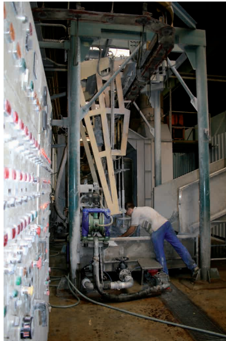
Flow Coating-Verfahren (Tumel-Emailier-Verfahren)
