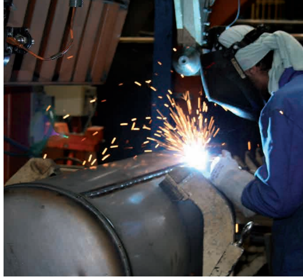
Schweissen der Speicher
